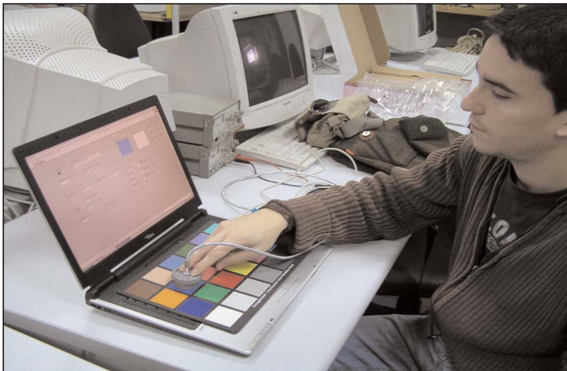
La Unitat de Gràfics i Visió per Ordinador i Intel·ligència Artificial del DMI i el grup de recerca d'electrònica del Departament de Física de la UIB ja han desenvolupat un primer dispositiu simplificat en què la tasca del microcontrolador i del sistema MDI és realitzada per un ordinador.
